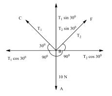
$T_1 \cos 30^\circ = T_2 \cos 30^\circ$
