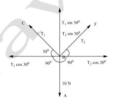
$T_1 \cos 30^\circ = T_2 \cos 30^\circ$
